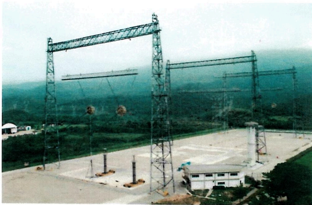
Foto 1 – Vista geral do Laboratório de Ultra Alta Tensão Externo, com arranjo de ensaio de LT de \pm 800 posicionado.
