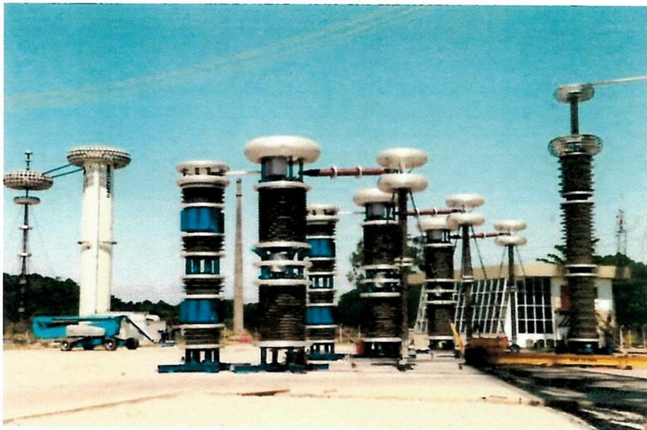
Foto 4 – Fontes de tensão montadas no pátio do Laboratório de UAT.
