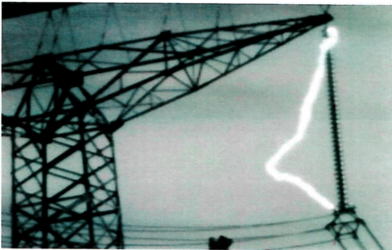
Foto 3 – Descarga na cadeia de isoladores do arranjo de LT de \pm 800 kVcc durante a realização de ensaios de impulsos de manobra.
