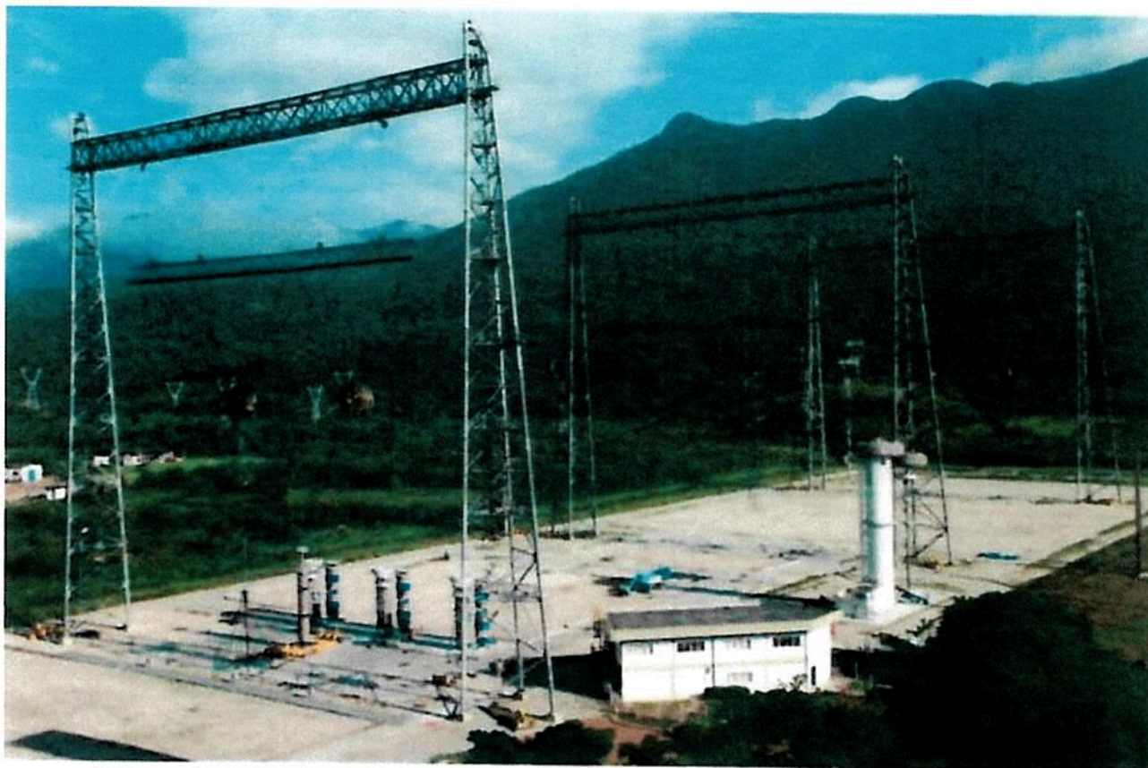
Foto 5 – Vista geral do Laboratório de Ultra Alta Tensão Externo, com as fontes de ensaio e o arranjo de LT de \pm 800 kVcc.
